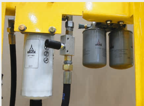
Sistema de filtro de combustible multietapa.
