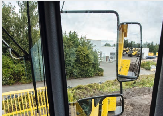
Grandes retrovisores a los dos lados que sirven de conexión con las grandes superficies acristaladas, creando una visión óptima en todas las direcciones.
