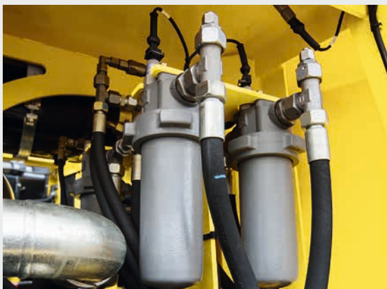
Sistema de filtrado por el lado de presión en el circuito hidráulico.
