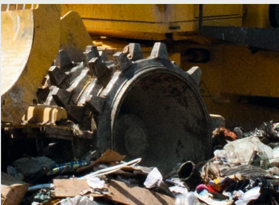
Los rascadores mantienen limpias las ruedas, garantizando así una compactación óptima.
