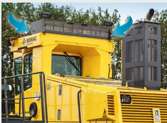
Punto elevado de aspiración del aire de refrigeración y combustión con la mínima contaminación de polvo.
