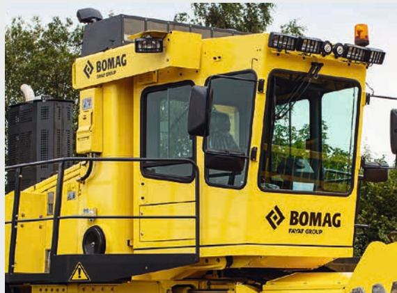
El diseño de la cabina sigue las disposiciones ROPS y FOPS.
