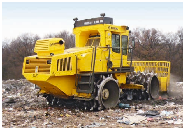
La plataforma de trabajo facilita el acceso a la zona de mantenimiento.
