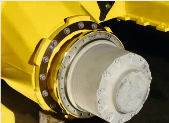
Dos sistemas autónomos de frenado (hidrostático como freno operativo y de discos múltiples como freno de retención).
