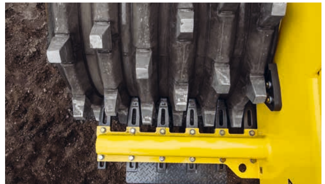
Rascadores reajustables para un funcionamiento sin anomalías.
