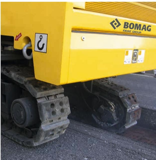
En los trabajos de canalización se pueden extraer en un solo ciclo de trabajo las capas portante, de ligante y de desgaste. La óptima distribución del peso permite alcanzar una buena tracción manteniendo la rodada.
