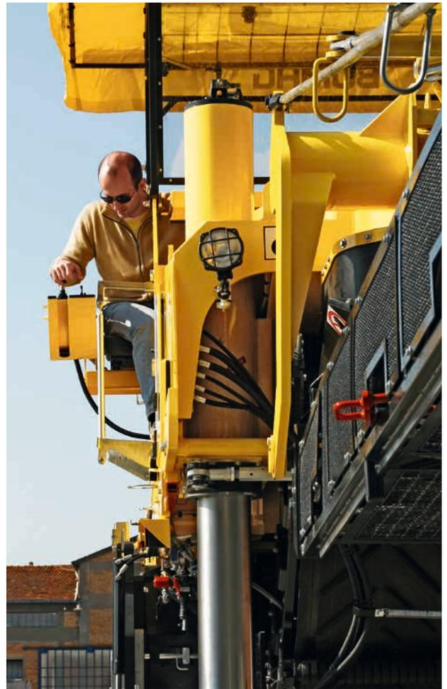
El asiento del conductor, desplazable hacia el exterior, un pedal aislado de las vibraciones y un cómodo apoyabrazos con las funciones principales le permiten al conductor seguir sin fatiga y con precisión carreteras comarcales con muchas curvas.
