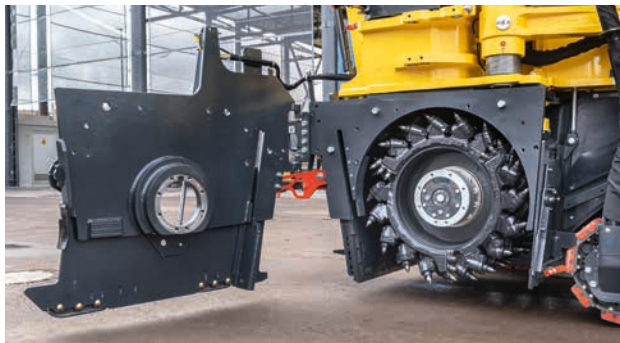
Protección anti desgaste intercambiable de metal duro para la caja de fresado y el tambor de fresado.
