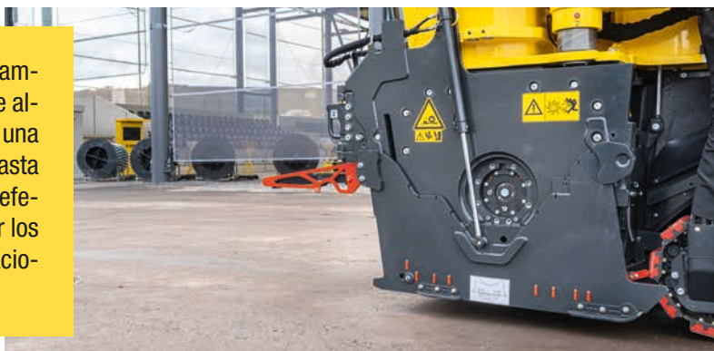
Protección anti desgaste intercambiable de metal duro para la caja de fresado y el tambor de fresado.
