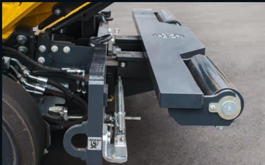
Rodillos de empuje amortiguados: con ajuste hidráulico y apoyo pendular.
