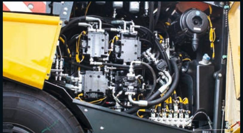
Fiabilidad: El sistema hidráulico funciona según la demanda, suministrando exactamente la potencia requerida.
