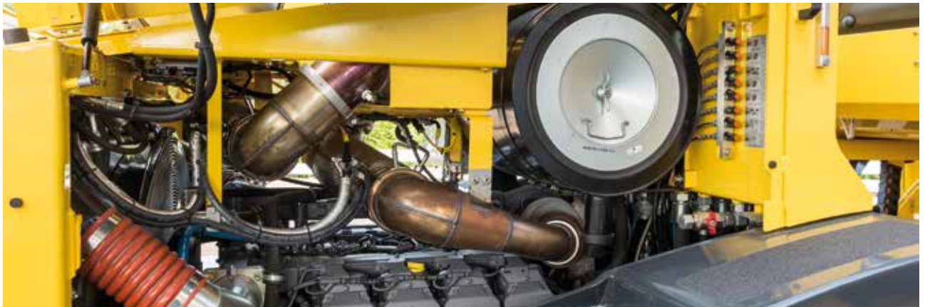
TIER 4 final con sistema SCR doble.
