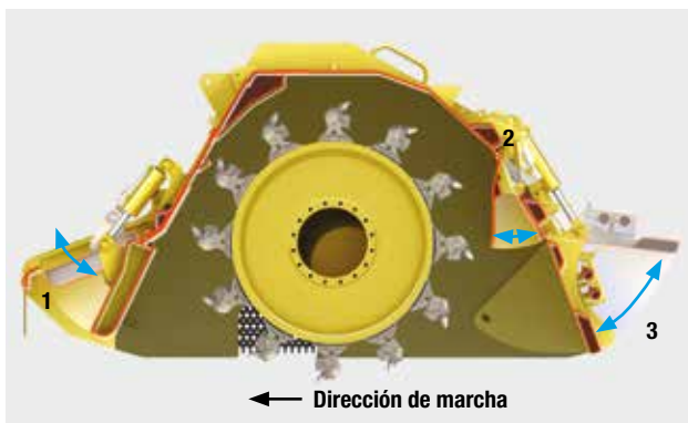
1) Tapa delantera y de machaqueo, 2) Tapa de mezclado y trituración, 3) Tapa trasera y de trabajo.
