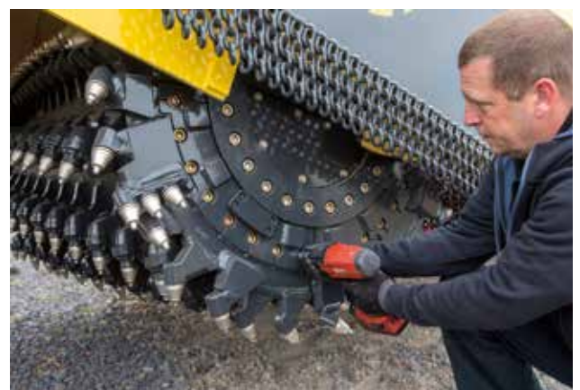
Cambio de los segmentos del borde sin desmontar el rotor.
