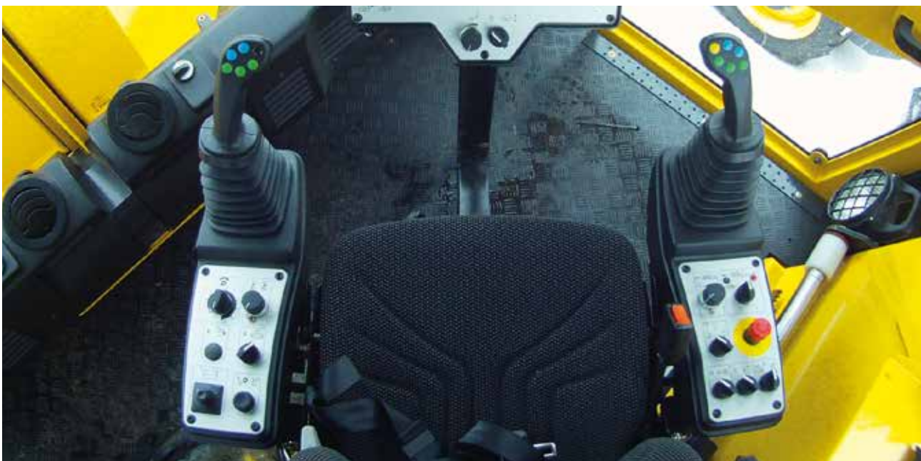
Dos joysticks en los reposabrazos para manejar la máquina con facilidad.
