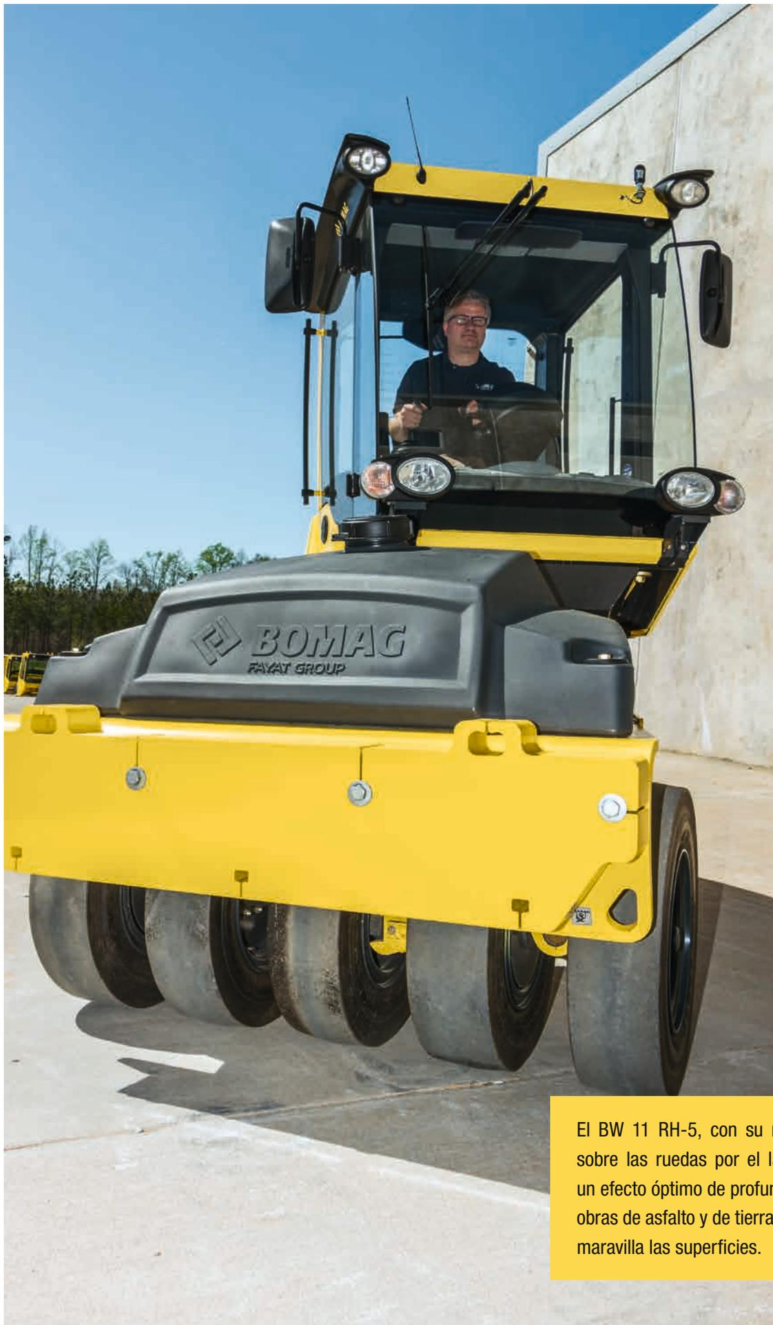
El BW 11 RH-5, con su mayor carga sobre las ruedas por el lastre, ejerce un efecto óptimo de profundidad en las obras de asfalto y de tierra, sellando de maravilla las superficies.
