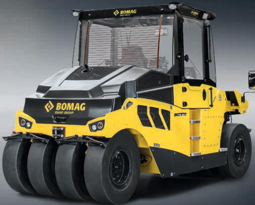
El rodillo de neumáticos BW 28 RH de BOMAG, con un peso en funcionamiento por encima de 8,6 t, es la mejor elección para numerosas aplicaciones. Garantiza siempre la máxima productividad y confort de uso, tanto con cabina como con ROPS.
