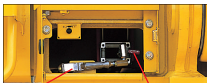
Pistola engrasadora La pistola engrasadora es accesible desde el suelo Indicador
