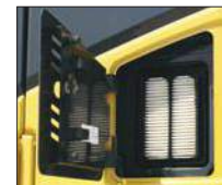
Filtro de aire externo del acondicionador de aire
