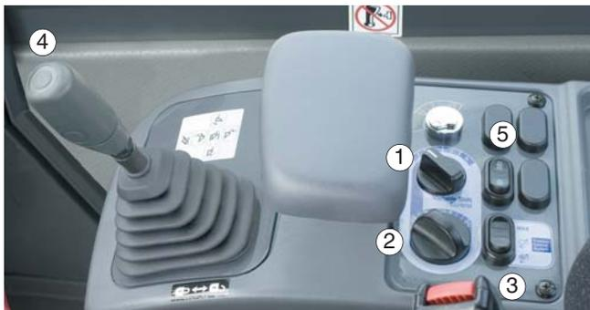
1:Interruptor selector del rango de velocidad 2:Interruptor de control de cambios variable 3:Interruptor de control de tracción 4:Interruptor de Tracción Máxima 5:Interruptor para la inversión de rotación del ventilador
