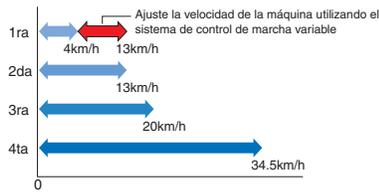
El interruptor de control de cambios variable permite al operador ajustar la velocidad de la máquina para aplicaciones de carga en "V" en sitios confinados. En 1, el operador puede ajustar la velocidad de traslado utilizando el interruptor de cambios variable para equiparar la velocidad de la máquina y del equipo hidráulico a la distancia de traslado.
