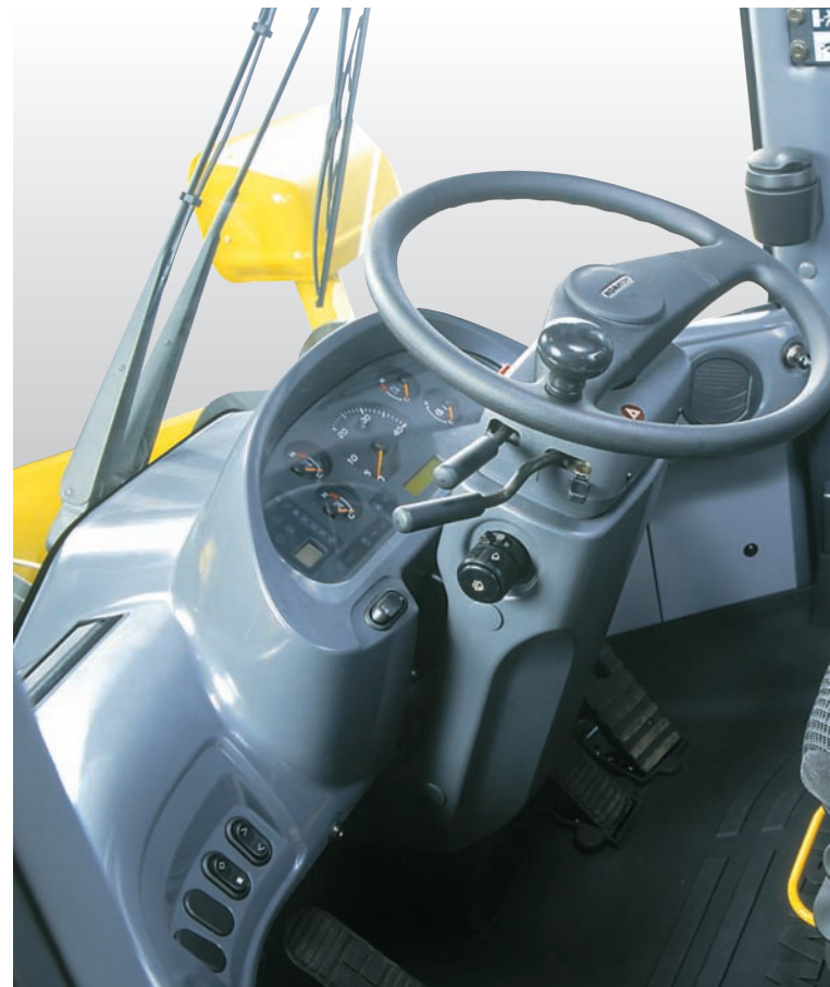
1: Interruptor de activación de corte (ON/OFF) 2: Interruptor para configurar el corte de la transmisión 3: Interruptor de activación de rotación contraria del ventilador(ON/OFF) 4: Palanca del aguilón 5: Palanca del cucharón
