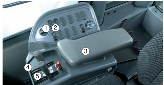
1: Interruptor de activación de corte (ON/OFF) 2: Interruptor para configurar el corte de la transmisión 3: Interruptor de activación de rotación contraria del ventilador(ON/OFF) 4: Palanca del aguilón 5: Palanca del cucharón
